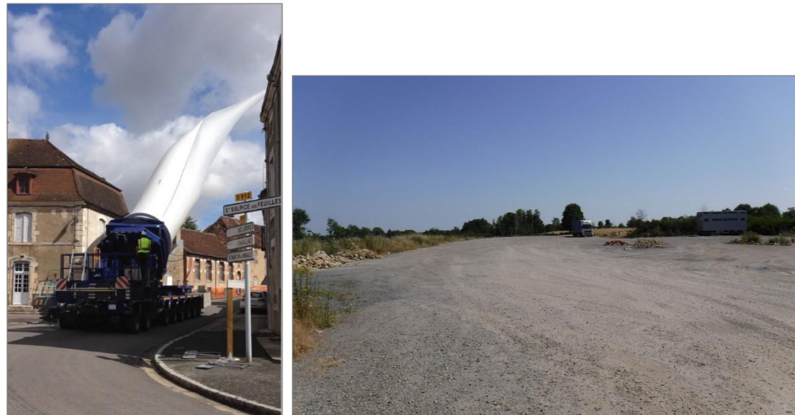
Photographie 32 : Transport d'une pale sur blade lifter (gauche) et plateforme de chargement envisagée en sortie de l'autoroute A20
